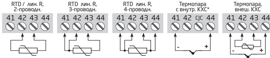
\* В случае перепрограммирования с измерения температуры через разъем с КХС на аналоговое измерение следует демонтировать разъем КХС. Заказывается отдельно: разъем с компенсацией хол. спая типа 5910 / 5910Ex для канала 1.
