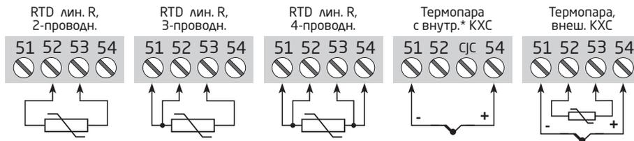
\* В случае перепрограммирования с измерения температуры через разъем с КХС на аналоговое измерение следует демонтировать разъем КХС. Заказывается отдельно: разъем с компенсацией хол. спая типа 5913 / 5913Ex для канала 2.
